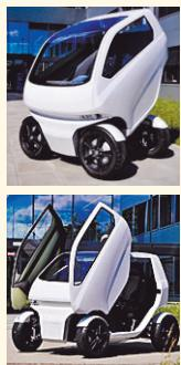
кой. Двери открываются вверх, позволяя водителю и пассажиру беспрепятственно садиться и покидать салон. Электродвигатель разгоняет автомобиль до 65 км/ч. В настоящее время несколько опытных образцов EOssc2 проходят испытания в Германии и Китае.
