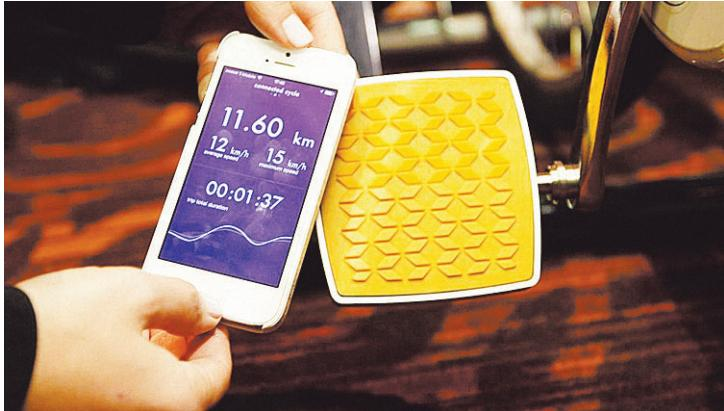
**Н**а площадке Indiegogo профинансирован проект «умных» педалей Connected Cycle Pedals, наделяющих обычный велосипед дополнительными функциями. Внутрь изделия встроены сенсоры, приёмник спутниковых навигационных систем GPS/ГЛОНАСС, низковольтный микроконтроллер и модуль для передачи данных через сотовую сеть. Получаемая во время поездок информация отправляется в сетевое облако, откуда её можно загрузить в
