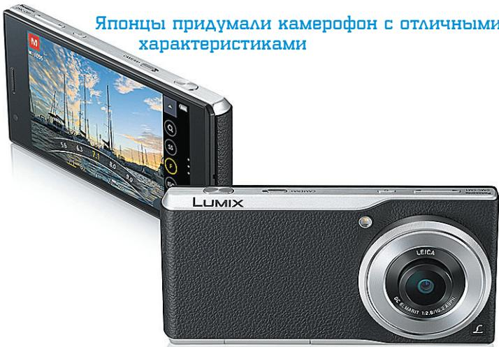
**K**омпания Panasonic представила в Японии камеру Lumix DMC-CM10, по коммуникационным и функциональным возможностям почти дотягивающую до звания смартфона. Модель оснащается 4,7-дюймовым дисплеем с разрешением Full HD, процессором Qualcomm Snapdragon 801, 2 Гб оперативной, 16 Гб встроенной флеш-памяти, слотом для карточек microSD и работает под управлением операционной системы Android 5.0 Lollipop. Устройство
