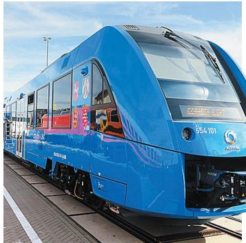
водяные капли. Топливо будет заправляться в специальные ёмкости. Одной полной заправки водородом будет достаточно для преодоления 800 км пути. Первыми заказчиками Alstom стали германские железнодорожники. Они заказали изготовить 14 составов, которые будут курсировать в Нижней Саксонии.
