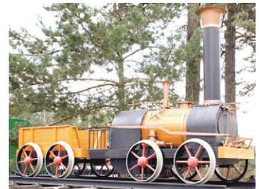
(853,5 метра) чугунным колёсопроводам (то есть рельсам). Он показал на деле, что может возить более 200 пудов (3,3 тонны) тяжести со скоростью от 12 до 15 вёрст в час (13-16 км/ч)».
