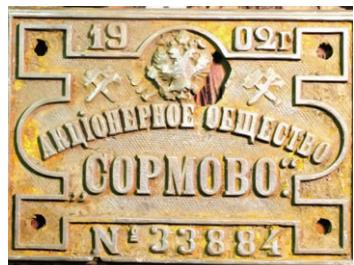
шильды с вагона. Ведь в позапрошлом веке они крепились к вагону не на болты: раскалённая заклёпка вставлялась в отверстие, после чего её разбивали молотком. Такое крепление отличалось особой надёжностью, его можно только срубить или срезать слесарным инструментом. Такие шильдики промышленность сейчас уже не выпускает. Как нет, по сути, и самого слова. Сейчас в российской технической документации используют термин «табличка устройства».
