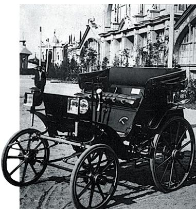
ретателя Петра Фрезе. Конструкция Яковлева – Фрезе была создана как серийный коммерческий автомобиль. Первый русский автомобиль весил около 300 кг и мог развивать скорость до 20 км/ч. Запас бензина позволял двигаться непрерывно 10 часов. Так в России начинался автомобильный век.
